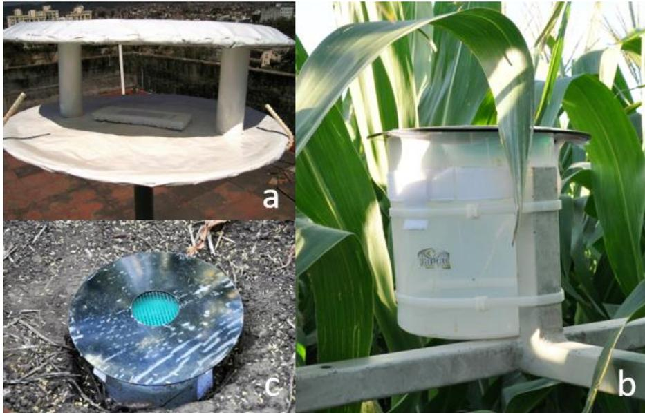
Figura 3: Ejemplo de muestreadores pasivos gravitacionales: a) Trampa Durham: la protección superior previene el lavado por precipitación del material colectado en el cubreobjetos del interior, b) Trampa Tauber colocada dentro de un cultivo de maíz, c) detalle de la parte superior de una trampa Tauber colocada a ras del suelo
